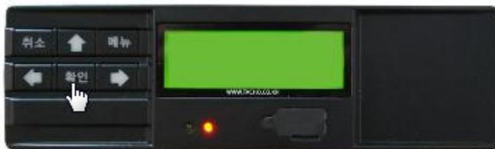
차량 전원이 꺼져있는 상태에서 [확인] 버튼을 누르면 자동으로 데이터가 수집됩니다. 수집은 초기 설정된 기준일을 수집하며, 수집 날짜 범위를 변경하려면 다음과 같이 수집 기준을 변경하여야 합니다.
